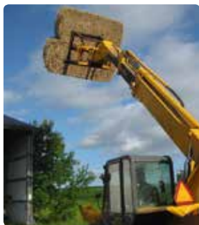
Teleskoplæsser med to rækker spyd i hver sin bigballe.
